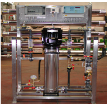
Impianto ad Osmosi Inversa
